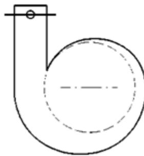
图 6 垂直于蜗壳平面或弯头平面的取压孔
