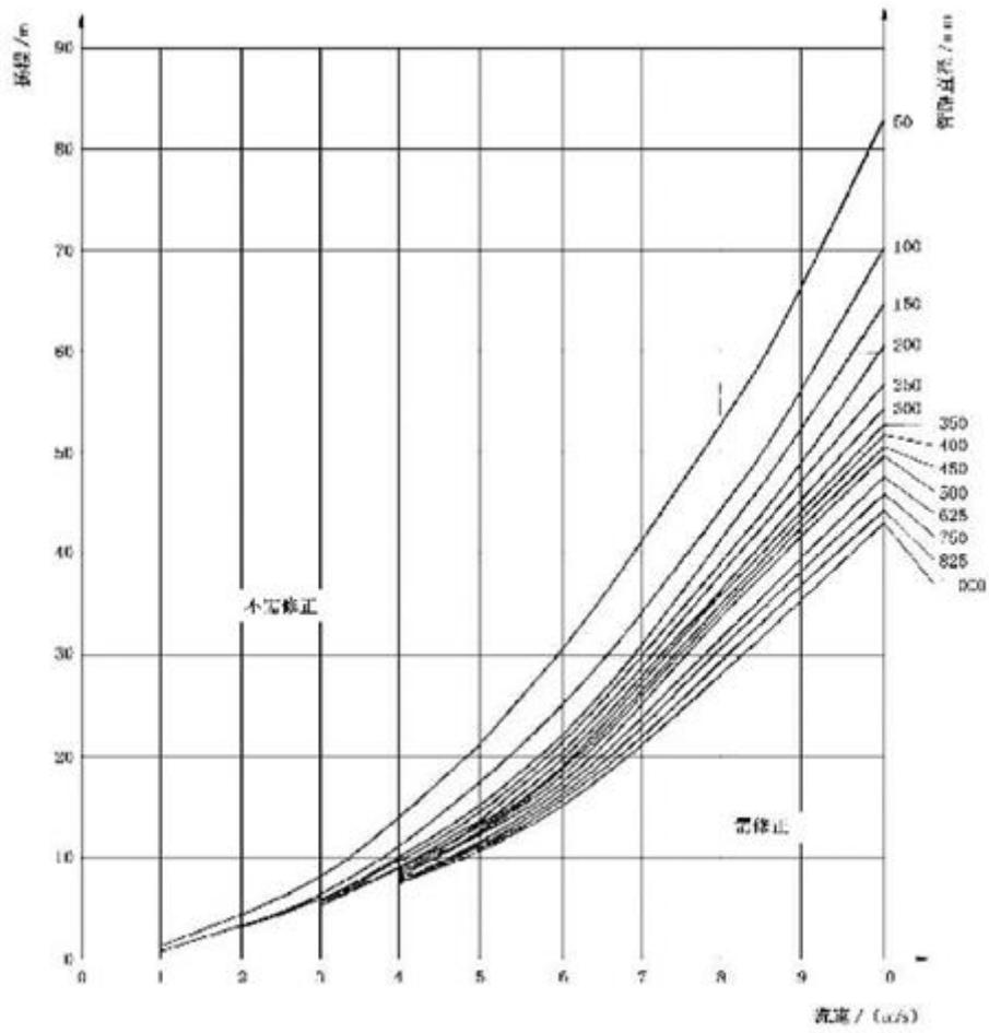
图 E. 2 2 级试验场合需要进行损失修正的流速界限指示图。
