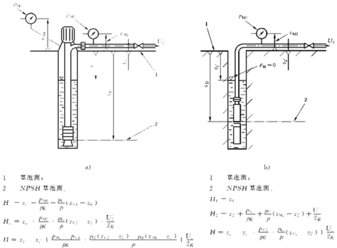
图 7 各种类型潜没式泵扬程的测量
