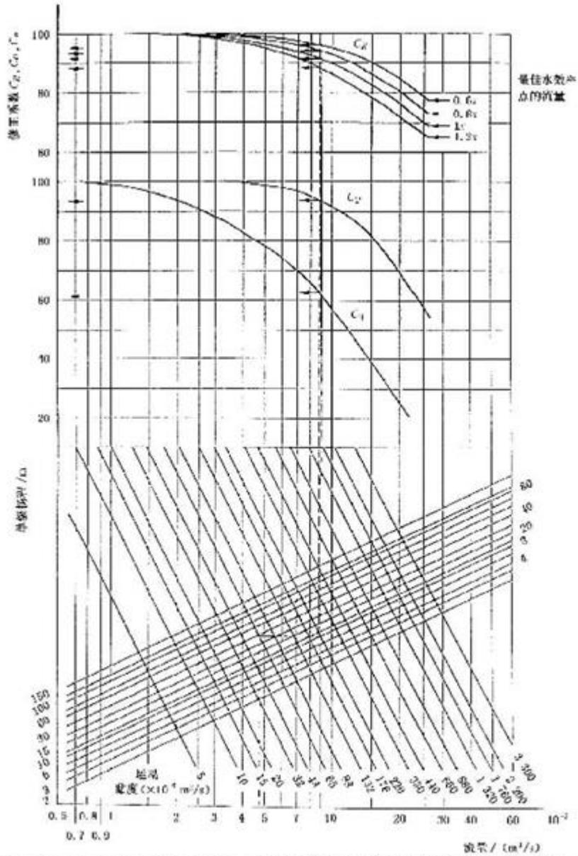
注：此图所示的值是根据口径为 DN50 至 DN200 的普通单级离心泵输送石油的试验得出的平均值。这些数据系根据水力学会标准 (HIS) - 1985 - ...
